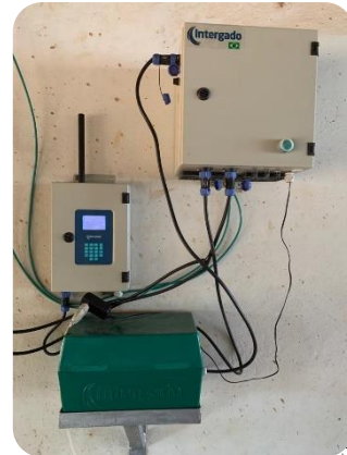
Intergado Tecnologia® (Realtime Sow Monitoring System)
